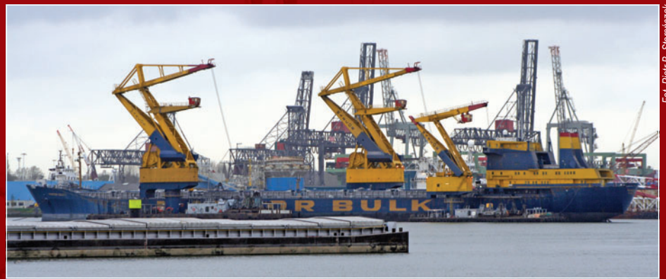
Ciekawostka z Wallhaven w Rotterdamie - polskiej budowy (z 1975 r. ze Stoczni Szczecińskiej) masowiec typu B447 (nr budowy: 23) – Marcor Bulk I (ex Trinec) używany jako magazyn pływający przez firmę przeładunkową Marcor Stevedoring.
