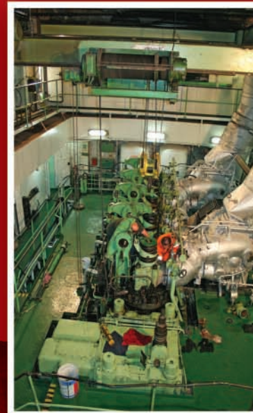
Górna część silowni i głowice silnika głównego wyprodukowanego w Stoczni Gdańskiej.
