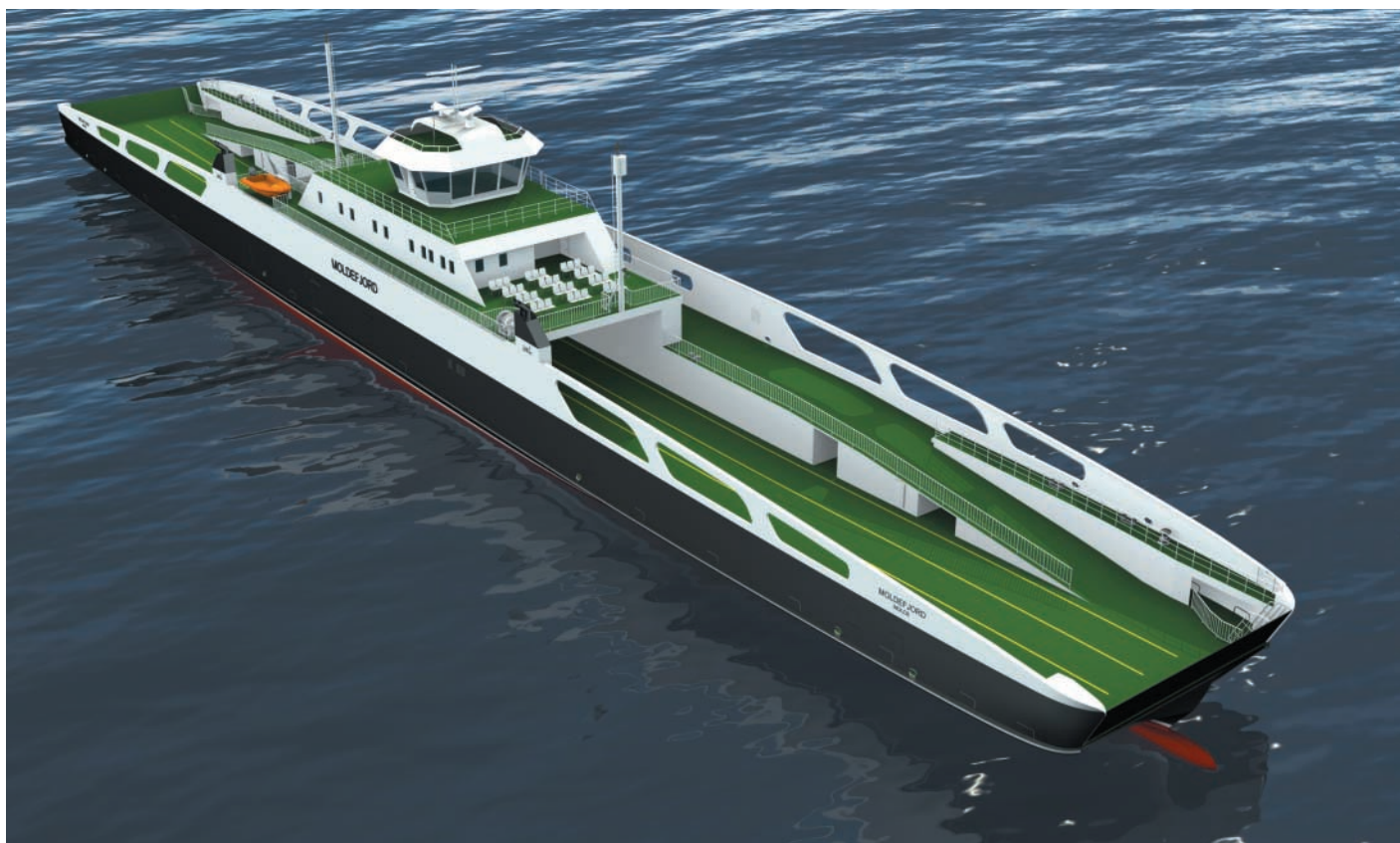
Prom przelotowy, symetryczny, z napędem LNG budowany w Remontowej SA.
