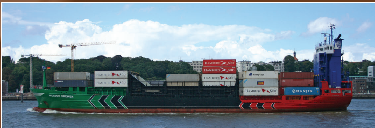
Werder Bremen - pojemnikowiec dowozowy bezpokrywowy o nośności 7144 t i ładowności 700 TEU (108 TEU w ładowni zamkniętej, 324 TEU w ładowni bez pokrywy i 268 TEU na pokładzie). Statek zbudowany w 1999 roku przez J.J. Sietas Schiffswerft GmbH & Co. KG - Hamburg, należy do Beluga Shipping GmbH z Bremy.
