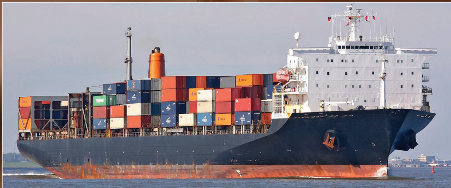
Oslo Express - pojemnikowiec o nośności 44 966 t i ładowności 3322 TEU, zbudowany w 1987 roku przez japońską stocznnię Mitsui Eng. & SB. Co. Ltd. - Tamano. Statek ten należał do Wilmington Trust Co. z USA, ale w chwili wykonania tej fotografii, był w czarterze Hapag-Lloyd AG. W kwietniu tego roku, już pod nazwą Lilly 3 został odstawiony do stoczni złomowej w Indiach.
