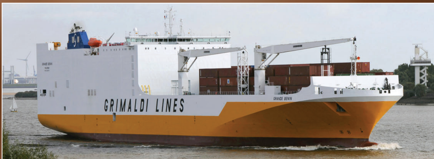
Grande Benin - klasyfikowany jako samochodowiec o ładowności 3400 samochodów, może również zmieścić na pokładzie 800 kontenerów 20-stopowych (nośność 26 097 t). Zbudowany został kosztem 66,66 mln USD w 2009 roku w chorwackiej stoczni Uljanik Brodogradiliste dd z Puli dla Grimaldi Group.
