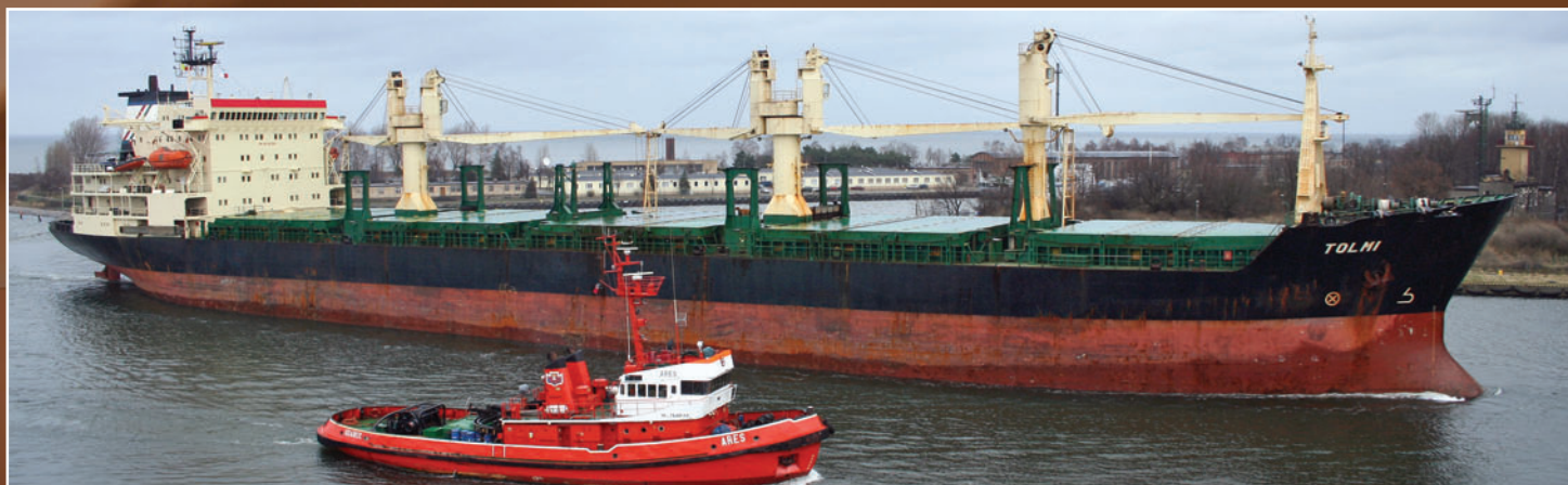
Tolmi - ex Finnwood , ex Lanka Abhaya , ex Finnwood , ex Pisces Venturer ; zbudowany przez Stocznnię Gdańską im. Lenina pod numerem budowy B539/02 w roku 1989; GT 21 305, nośność 29 094 t, ładowność 1100 TEU, długość całkowita 184,51 m.
