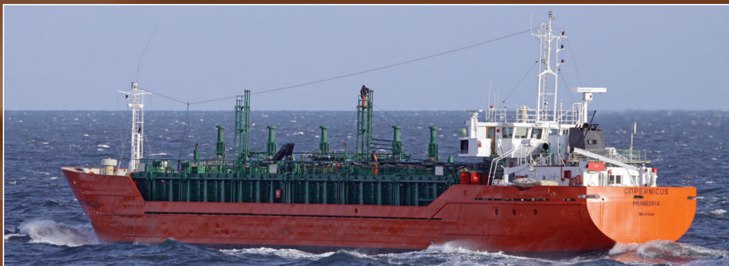
Copernicus - mały chemikaliowiec ze zbiornikami samonośnymi (nr IMO 8713809, ex Arklow Manor , zbudowany w 1987 r. w stoczni Peters & Co. w Niemczech, przebudowany w 2001 r. w Stoczni Remontowej Nauta SA z rzeczno-morskiego statku wielozadaniowego); nośność 2181 t, GT 1525, długość 73,85 m; eksploatowany przez Seatrans Chemical Tankers AS z Norwegii i obsadzony najprawdopodobniej polską załogą. Częsty gość w polskich portach, zwłaszcza w Gdańsku.
