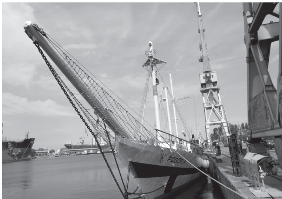
Na Pogorii w wyniku niewłaściwego przyspawania podkładek wewnątrz masztu (od dołu, a nie od góry) zbierała się wilgoć, która powodowała korozję.
