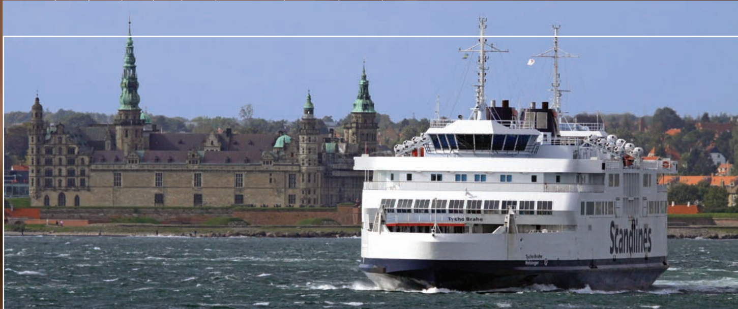
Tycho Brahe – zbud. w 1991 roku w norweskiej stoczni Langsten - tej samej, w której powstał nasz prom Polonia , 111 m długości, 238 samochodów osobowych, 1250 pasażerów, eksploatowany jest przez Scandlines GmbH.
