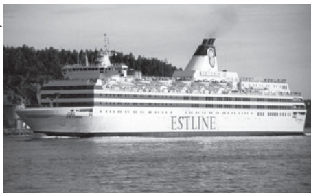
Estonia natrafiła na takie warunki falowania, przy których uderzenie fali zerwało przyłbicę i przez otwarty dziób woda wtargnęła na pokład samochodowy, i przewróciła prom.
