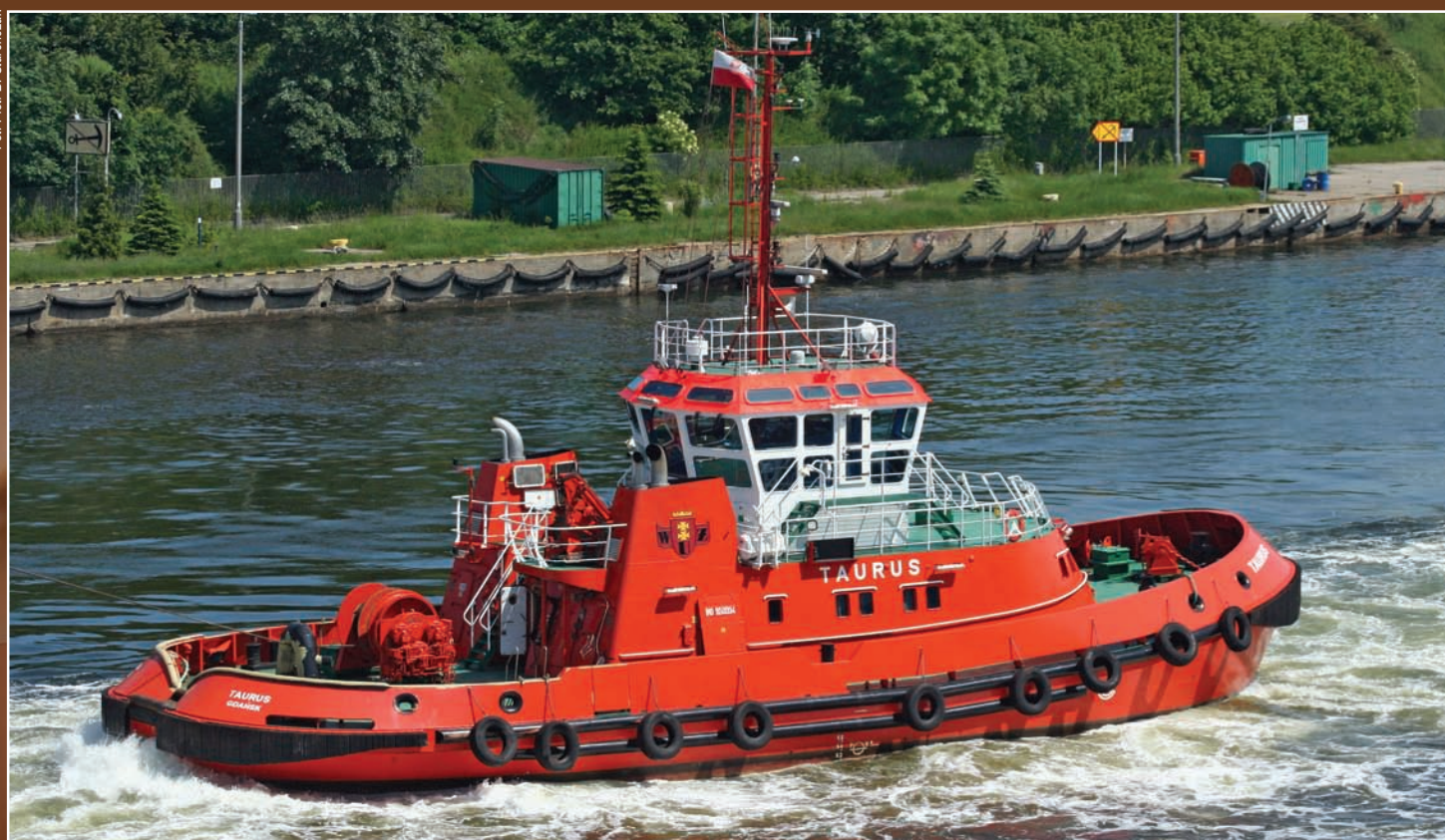
Taurus (IMO 7212171, sygnał wywoławczy SQDM); długość całkowita 30 m, moc napędu głównego 2460 kW (3344 KM); prędkość maks. 11,4 węzła, uciąż na palu 42 T; wyposażony we wciągarkę 42 T o sile trzymania 100 T.
