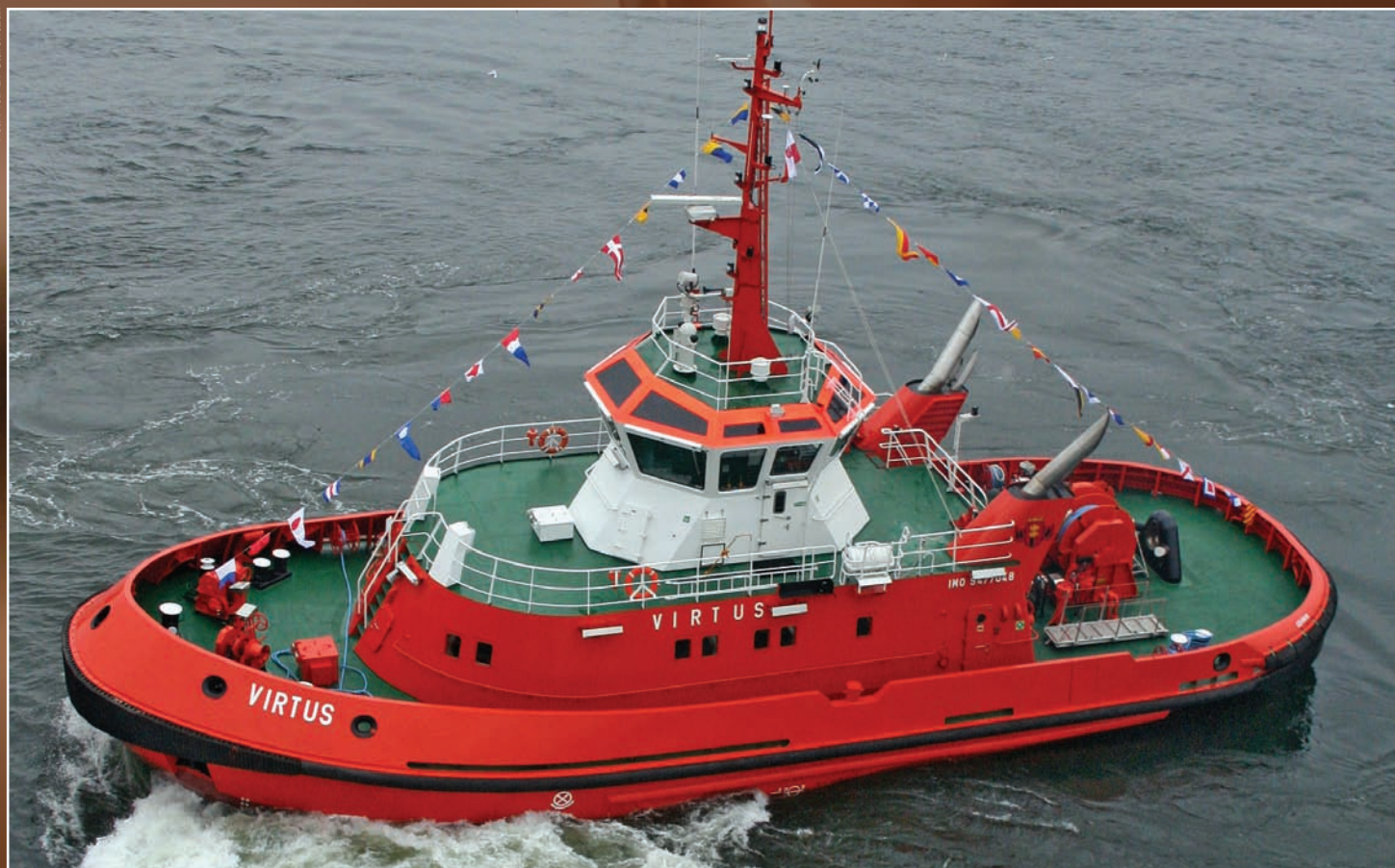
Virtus (IMO 9477048, sygnał wywoławczy SPKN); długość całkowita 31,2 m, moc napędu głównego 3530 kW (ok. 4800 KM); prędkość maks. 13,4 węzła, uciąż na palu 56 T; wyposażony w hydrauliczną wciągarkę holowniczą.
