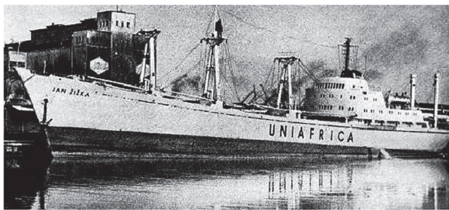
Drobnicowiec Jan Żiżka – długość: 124,9 m, szerokość: 16,5 m, zanurzenie: 6,6 m.
